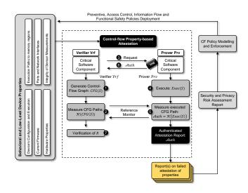
Fig. 3. CFPA Work Flow
